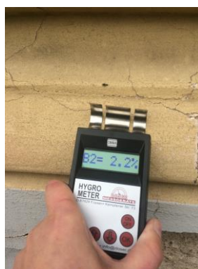
Místa a hodnoty vlhkosti v jednotlivých partiích soklu a plochy fasád
