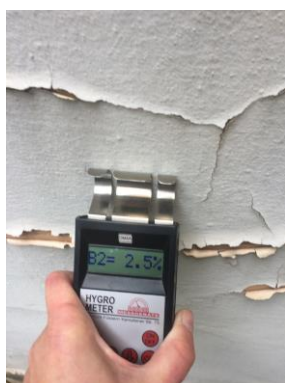
Místa a hodnoty vlhkosti v jednotlivých partiích soklu a plochy fasád
