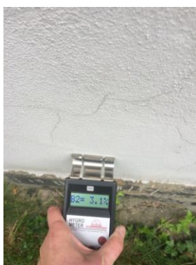
Místa a hodnoty vlhkosti v jednotlivých partiích soklu a plochy fasád
